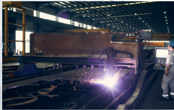
數控等離子切割機 (CNC plasma cutting machine)
